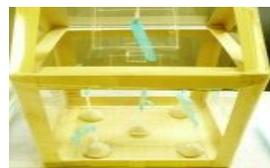
図1 通風実験部屋模型
