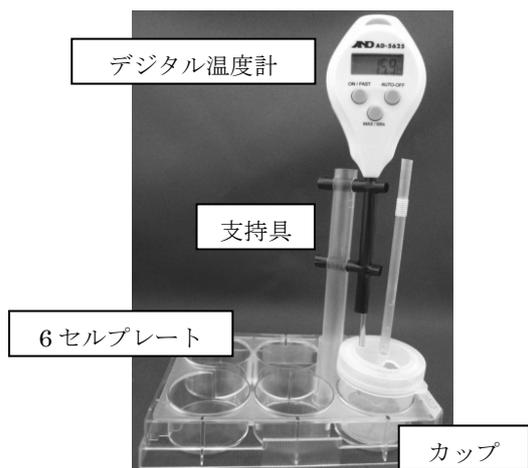
図 1. 実験器具の概観
