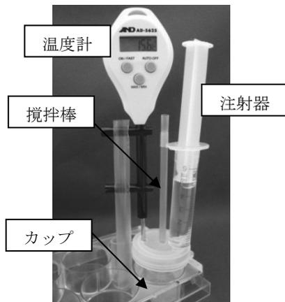
図 4. 注射器による注入
