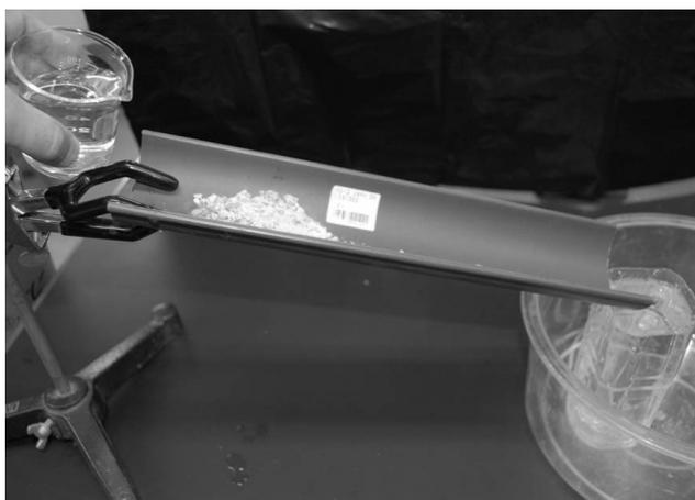
図4 雨どいを用いた堆積実験
